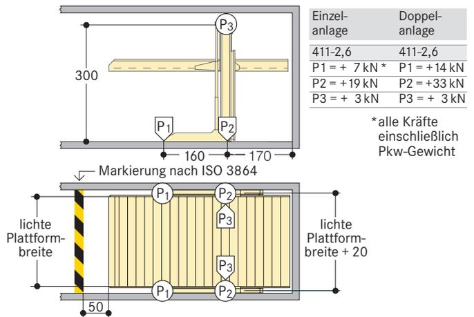
Die Anlagen werden an den Auflagerpunkten mit Schwerlastdübeln (Bohrlochtiefe 10 bis 12 cm) am Baukörper befestigt.
