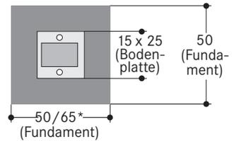
\* 65 bei Reihenanordnung in Einzelaufstellung für Fundamente dazwischen
