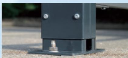
Befestigung am Boden durch Edelstahldübel auf bauseitigem Fundament, einstellbar auf lokale Gefällesituation bis 100 mm. Alle Verbindungselemente sind aus Edelstahl.
