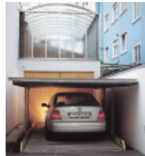
Bei der Renovierung einer Apotheke in der Innenstadt von Stuttgart sollten 5 Stellplätze in einer ca. 3 m breiten und 20 m langen Hofeinfahrt geschaffen werden. In die Zufahrt wurde eine Versenkgarage Parklift 462 für 2 Pkw eingebaut, bodenbündig und überfahrbar. Dahinter ein Parklift 413 für 3 Pkw.
