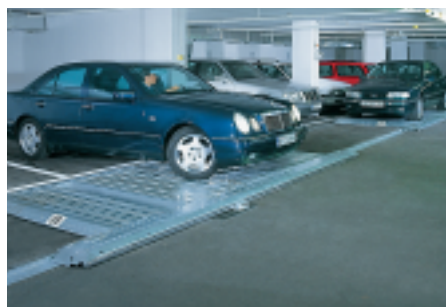
Die konventionellen Stellplätze hinter den Parkplatten sind leicht zu erreichen: sind die Parkplatten frei, kann man sie einfach überfahren, denn sie haben allseits abgeschrägte Kanten; sind sie belegt, werden sie einfach beiseite geschoben.
