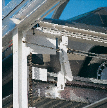
Die Plattformen hängen an Trageketten und werden in angehobener Stellung durch eine elektromagnetische Verriegelung gesichert.
