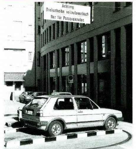
Welcher Autofahrer wünschte sich am Ende einer schmalen Sackgasse zum Wenden nicht eine Drehscheibe? Dieser Wunsch wurde im Zentrum von Basel Wirklichkeit – eine nachahmenswerte Einrichtung. Foto: autopress
