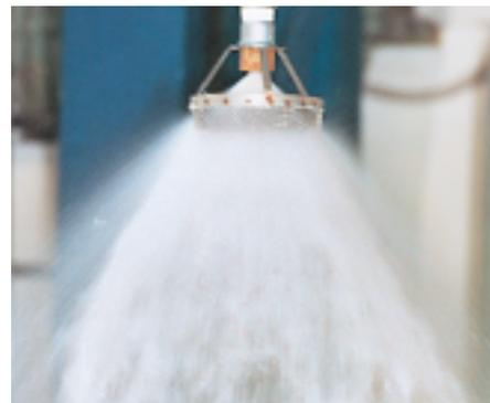
*Mittelschaumdüse mit einer Verschäumung von 1:50. Verschäumung heißt, daß aus 1 Liter Schaum-/Wassergemisch im vorlie- genden Fall 50 Liter Schaum entstehen.*
