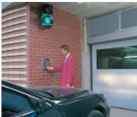
Zum Einfahren wird das Tor mit einer Magnetkarte geöffnet. Eine leere Parkplatte steht im Einfahrtsraum auf dem Vertikalförderer bereit.
