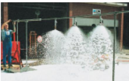
Oben: Mittelschaumrohr mit einer Verschäumung von ca. 1:75. Mitte: Leichtschaumdüse mit einer Verschäumung von 1:400. Unten: Vergleichssprühen von drei Düsen mit einer Verschäumung von 1:8, 1:50 und 1:75 (von links nach rechts).
