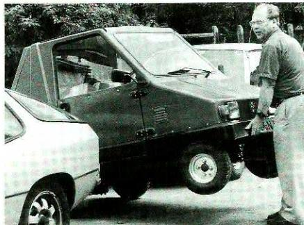
Der Betriebsschlosser Ernst Grabstein aus dem niedersächsischen Lüntorf bei Hameln findet für sein zwei Meter kurzes Auto Marke Eigenbau (4,5 PS) selbst in der Innenstadt immer noch irgendwo ein Plätzchen. Notfalls hebt er sein 120 Kilogramm schweres Gefährt per Hand an und schiebt es einfach in die Parklücke.
