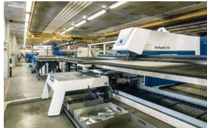
Für die Herstellung von Parksyste men stehen CNC-Blecbearbeitungsmaschinen für große Arbeitsbereiche zur Verfügung.
